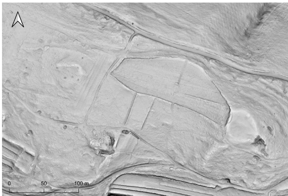
Figura 11: Visualizzazione di DTM LiDAR (slope e local relief model con 60% di trasparenza) a 50 cm di risoluzione dell'area occupata dal castelliere di Trmun.
